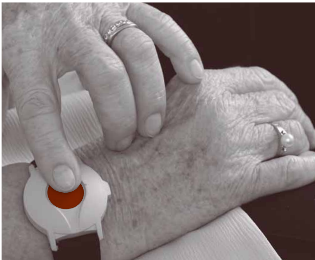
Der Druck auf den Notruf-Knopf löst den Alarm bei der Medizinischen Notrufzentrale aus
